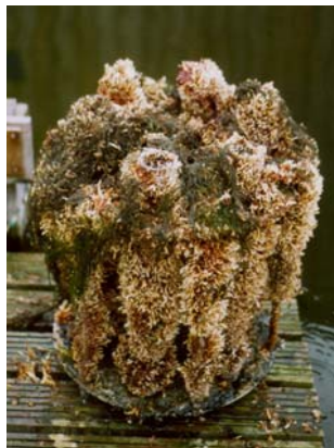
..... Figuur 2.3 Sedimentval na verblijf van 3 maanden gedurende de zomerperiode in het oppervlaktewater (foto's: P. de Rijke).
