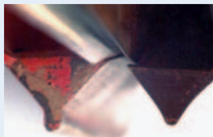
Links een scherp kouter met de juiste druppelvorm (vier mm breed en vijf mm hoog), rechts een versleten kouter.
