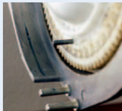
Bij de Monozentra kan na langdurig gebruik een slijtgroef in het zaaihuis ontstaan. Het beste is om een zaai strip te (laten) monteren.
