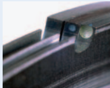
De rechter Monopill-schijf heeft door slijtage een putje van 2,5 mm diep. Deze schijf dient vervangen te worden.
