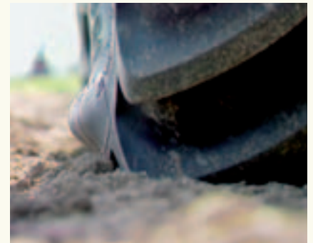
Een moderne radiaalband laat bij een juiste (lage) bandspanning zijn 'bolle wangen' zien. Rijden op lage druk geeft minder wielslip en bespaart daarmee 15 tot 20% op brandstof. Foto: Ludwig Volk
