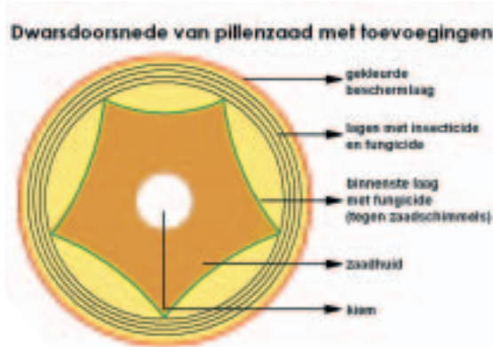
Figuur 1. Schematische dwarsdoorsnede van gepilleerd zaad, waarbij de inhuilmassa in lagen is aangebracht.
