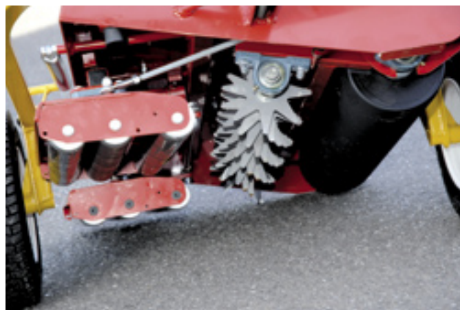
De Tru-Turf Roll & Slice bestaat uit twee pendelende sets van 3 lichte rollen. Die zijn goed bodemvolgend en doen door een soort fusee besturing ook dienst als stuurwielen. Naar keuze is het mogelijk om tijdens het rollen ook meteen te slitten.
