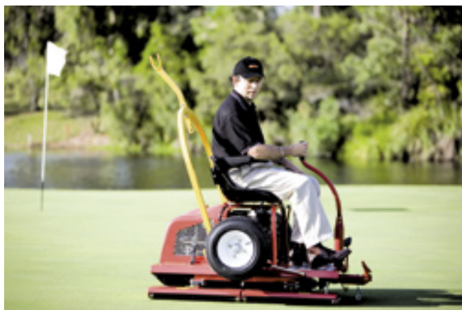
De Tru-Turf Roll & Slice bestaat uit twee pendelende sets van 3 lichte rollen. Die zijn goed bodemvolgend en doen door een soort fusee besturing ook dienst als stuurwielen. Naar keuze is het mogelijk om tijdens het rollen ook meteen te slitten.
