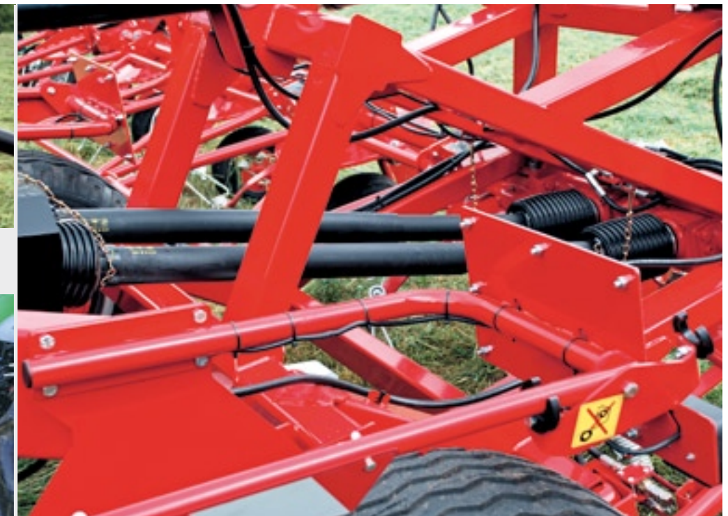
De schudder is voorzien van een dubbele aandrijving zodat de krachten in de aandrijflijn beperkt blijven. De aandrijving van de linker- en rechterkant zijn hierdoor gescheiden.
