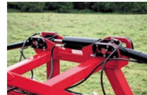
Een kunststof plaat op het sleufgat zorgt ervoor dat deze niet uitslijt door de pen.
