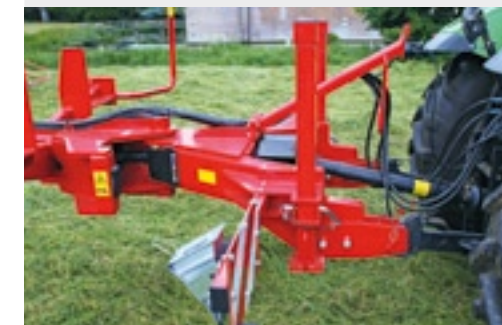
Het knikpunt ver achter de trekker zorgt ervoor dat de schudder nagenoeg spoorvolgend is.
