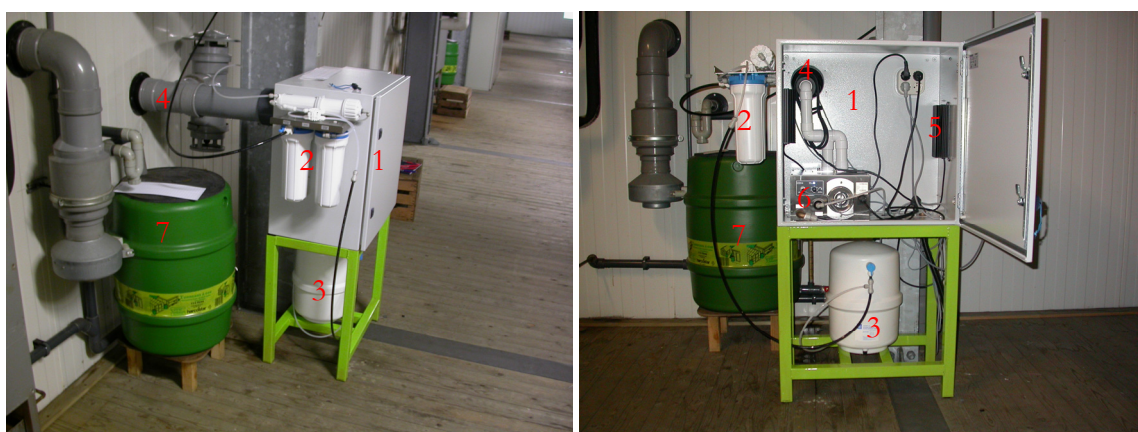
Afbeelding 1 Opstelling Contronics bevochtigingsinstallatie in deze test. Links de gesloten module zoals in bedrijf, rechts een blik in de geopende module 1) gasdichte systeemkast 2) waterfilterunit 3) voorraadvat gefilterd water 4) gecombineerde aanvoer cellucht / afvoer bevochtigde lucht 5) RV sensor/regelaar DRZ-43 6) Ultrasoon bevochtiger HU-25 7) opvangvat voor meting smeltwater van verdamper in de cel (hoort bij de reguliere celinrichting)
