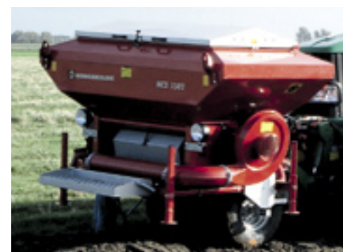
▲ De fronttank is voorzien van een uitklapbaar platform voor goede toegang.
