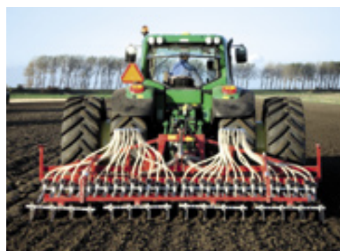
▲ Door de werkbreedte van 4 meter wordt de montage van 2x 650 banden mogelijk.
