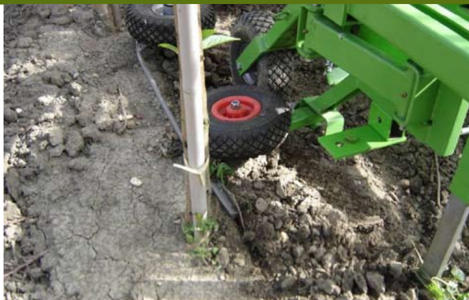
Mechanisch stuursysteem door middel van gewasgeleiding: Onkruidbestrijding tussen de rijen vindt plaats met drie ganzenvoeten die ieder voor zich bevestigd zijn aan een schaarelement. De ganzenvoeten overlappen elkaar een paar centimeter. Onkruidbestrijding vlak langs de boomrij wordt uitgevoerd met twee gewasgeleiders waar een schoffelmess aan bevestigd is van +/- 20 cm lang en 3 cm breed. Dit schoffelmess is zo geconstrueerd dat het zichzelf zo ver mogelijk tegen de boomrij drukt.
