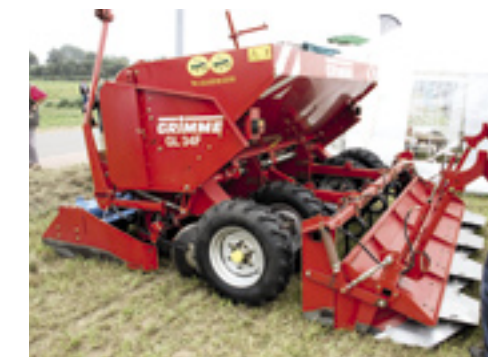
▲ Grimme pootmachine is stabiel door een verplaatste as.
