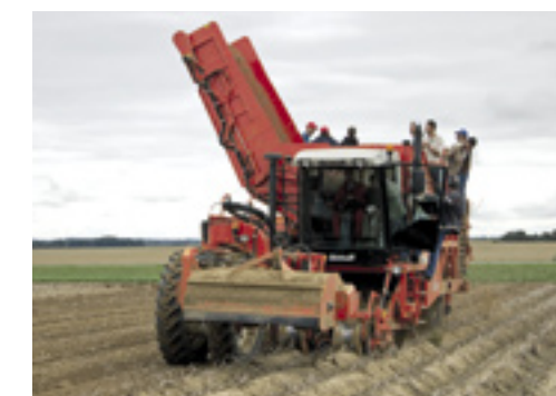
De tweerijige DeWulf rooier kan kort draaien met vierwielbesturing.
