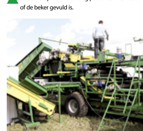
▲ Dewaele stortbak met dubbele kluitenscheider.
