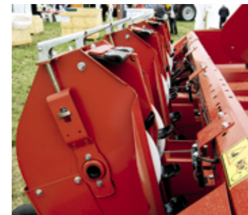
▲ Een tand op de Underhaug pootmachine voelt of de beker gevuld is.
