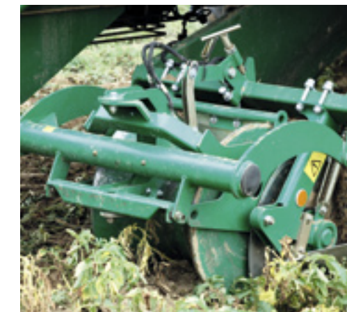
Twee sensoren houden de diabolo van WM precies boven de rug.
