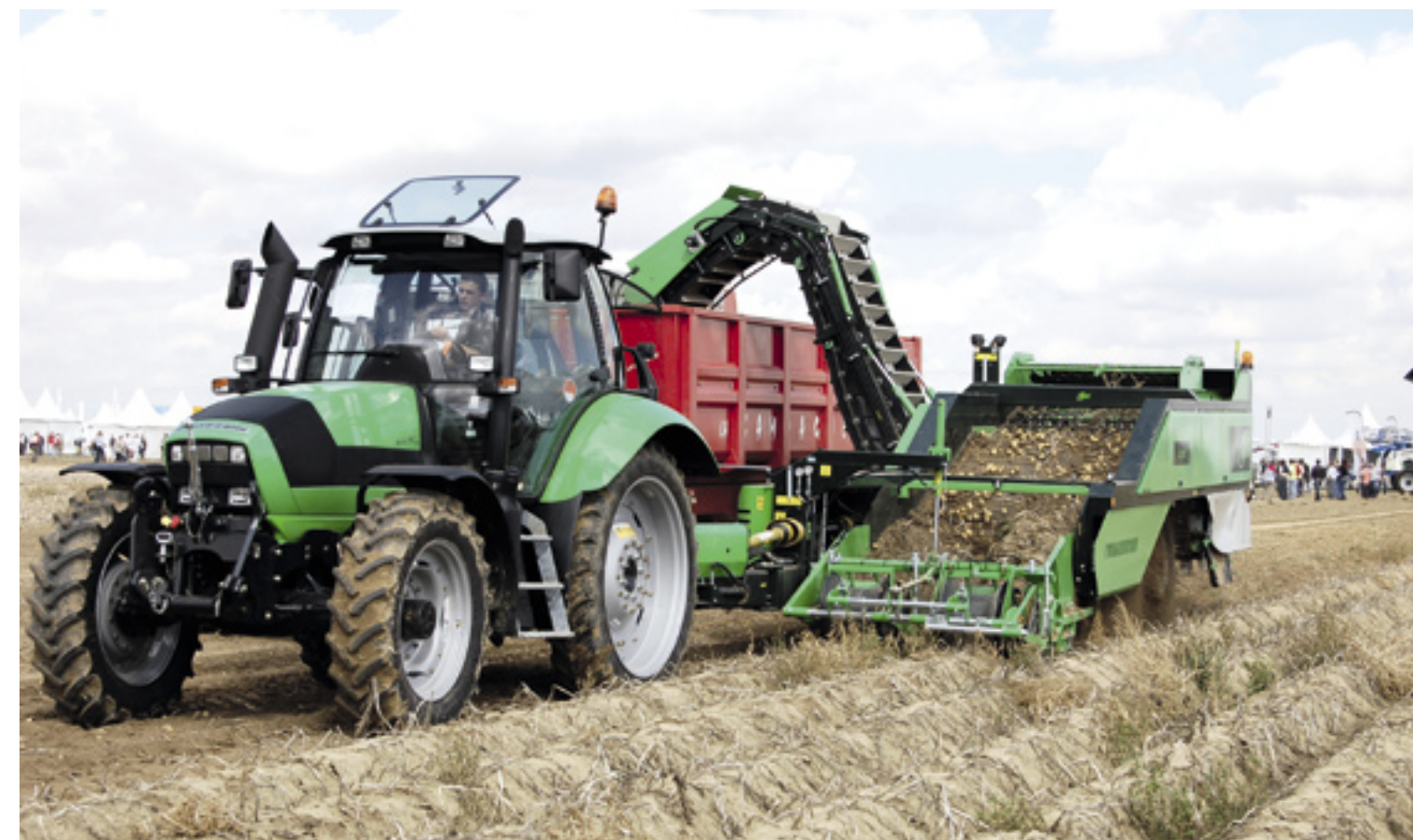
Op beide rooidemonstraties rooiden alle rooiers in verstek zoals deze tweerijige AVR. Dit geeft minder beschadiging.
