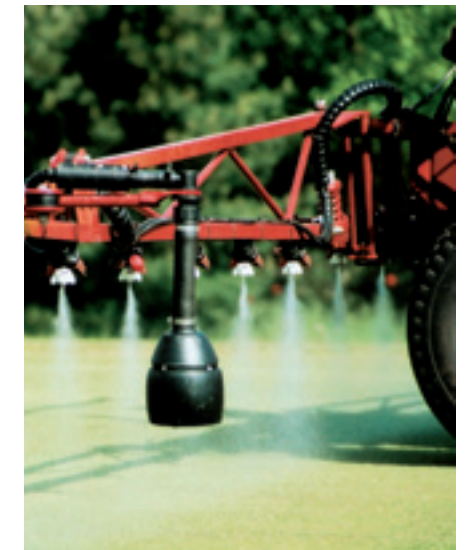
Een mooi egaal ogende nevel is nog geen garantie voor een goede verdeling. De hoogte van de spuitboom ten opzichte van de grond moet zo constant mogelijk blijven voor een optimale verdeling.
