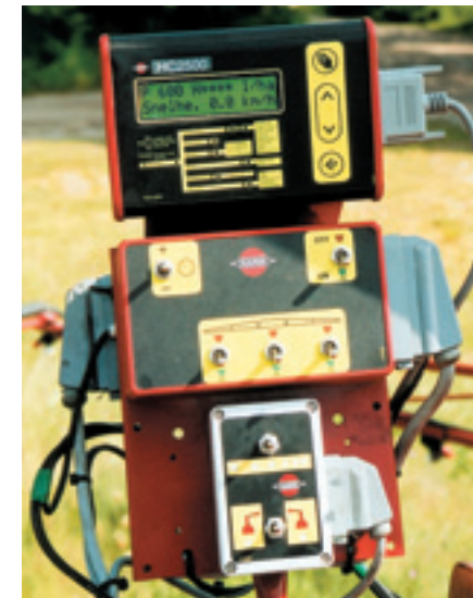
Een spuitcomputer maakt het heel eenvoudig om nauwkeurig de juiste hoeveelheid per vierkante meter te spuiten. Wisselingen in rijsnelheid worden door de computer automatisch gecompenseerd door de spuitdruk aan te passen.
