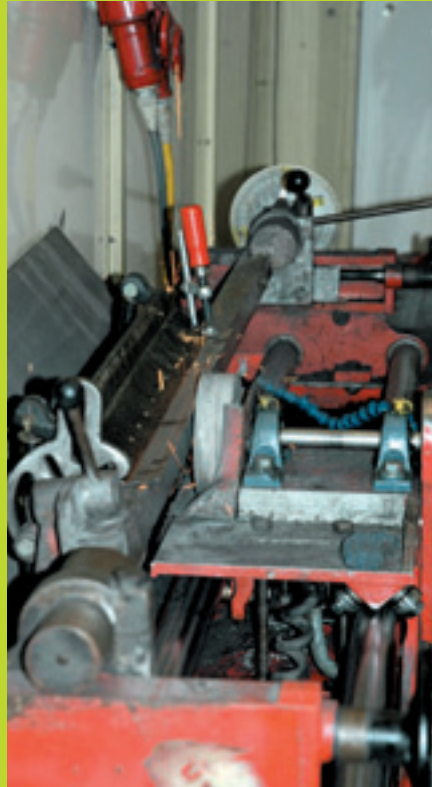
Slijpen is een klus die enige deskundigheid vergt maar waar ook goede en dus vrij prijzige apparatuur voor nodig is. Goed inspannen (links) is de kunst van het slijpen, de rest doet de machine (rechts).
