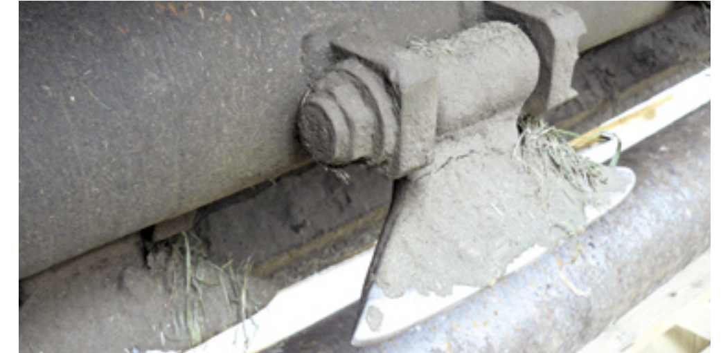
Pas op bij een vastzittende bout of moer. Voor je het weet is de zeskant rond gedraaid of breekt de bout. Dan kost het meer tijd om de klus te klaren. Neem even de tijd om dit te voorkomen.
