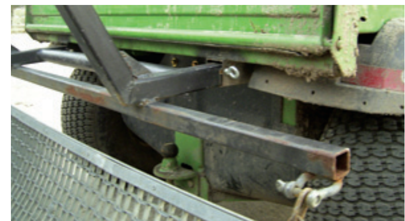
Om automatisch een sleepnet op te tillen maakten de greenkeepers van de Oosterhoutse Golf Club een frame aan een Gator. Deze zit aan de kokerbalk van de laadbak. Wanneer de laadbak omhoog staat, kun je slepen. Als je de laadbak omlaag doet, gaat het net omhoog en hangt aan vier kettingen aan de hefarm.
