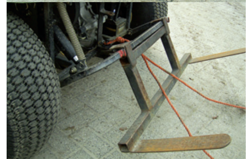
Via een soort pallet-lepels aan de bunkerhark kan het sleepnet vervoerd worden van hole naar hole. Het slepen zelf gaat via een touw.
