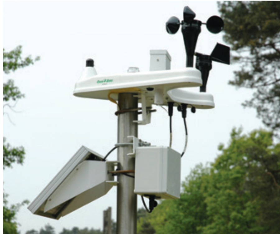
Een weerstation voorziet het managementprogramma van informatie als hulp om te bepalen of er berekend moet worden. De ET-waarde, zeg maar de verdamping, wordt berekend en die kan mede bepalend zijn bij de keuze hoeveel water er gegeven dient te worden. Vooral in droge, warme klimaten wordt er veel mee gewerkt. Kennis en inzicht van de greenkeeper blijft niet-temin van het grootste belang. Het weerstation kan niet zien hoe droog het werkelijk is op sommige plekken in de baan en houdt ook geen rekening met een op handen zijnde onweersbui.
