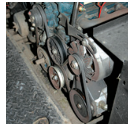
In standaard uitvoering heeft de Cushman één snaar om de hydrauliek pomp aan te drijven. Op de motor zit weliswaar een dubbele poelie, maar er is te weinig ruimte tussen de pomp en het chassis om ook daar een dubbele poelie te monteren.
