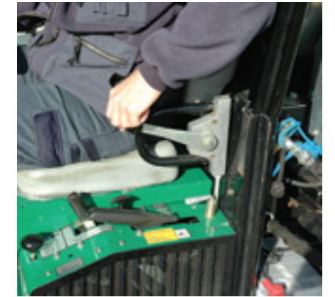
Er blijken typen bowdenkabels op de markt te zijn die beter gesloten zijn dan het type dat Cushman standaard toepast. Door de kabel door zo'n type te vervangen, blijkt het probleem van stug bewegende kabels prima te zijn opgelost. Ook de gewijzigde plaatsing – niet meer direct naast de beugel naast de zitting – blijkt de gebruikers goed te bevallen.
