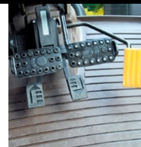
▲ De rijpedalen zitten onder de rempedalen, een om vooruit te rijden en een om achteruit te rijden.
