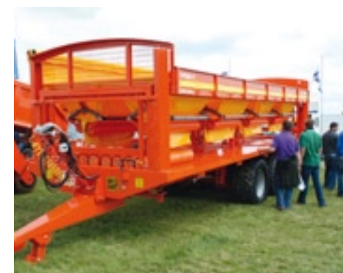
▲ Bij het lossen in kisten is beperken van de valhoogte een speciaal probleem. Fabrikant Larrington heeft daarvoor op zijn platte wagen een speciale opvangheid ontwikkeld. Nadat de kisten op de laadvloer zijn geplaatst, laat de chauffeur het raamwerk met de dichtgeklemde kunststof trechters in de kist zakken. Bij het roien vallen de aardappels eerst in die trechters. Door het al maar groter wordende gewicht gaan de trechters langzaam open en komen de aardappels met een geringe val in de kist terecht. Daarna wordt het frame geleidelijk omhoog getrokken, totdat de kisten vol zijn en gewisseld moeten worden.
