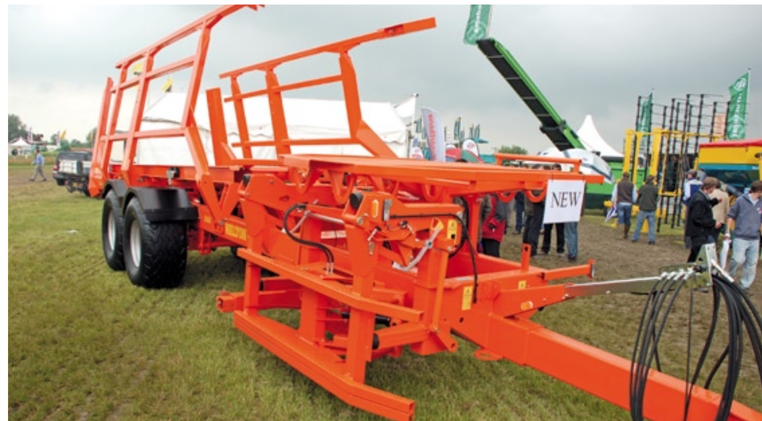
▲ De Eclipse balenverzamelaar van de firma Walton verzamelt grote stropakken uit verspreide ligging. Als de wagen langs een pak rijdt, neemt een uitstekende balk het pak mee. Tegelijk grijpen twee vorken in de zijkant en draaien het pak daarna op het eerste platform. Nadat een tweede pak is geladen, wordt het platform opgeklapt en beide pakken op de laadvloer geplaatst. Dat proces herhaalt zich, maar nu kan de bestuurder het platform over 90 graden draaien om verband in de stapel te brengen. Is de wagen vol, dan kan de laadvloer bij de berging recht op worden weggezet. Bij de maat 80x80x120 cm kunnen 21 tot 24 pakken worden opgetast. Bij 120x130x240 cm loopt dat aantal terug naar tien pakken per vracht.
