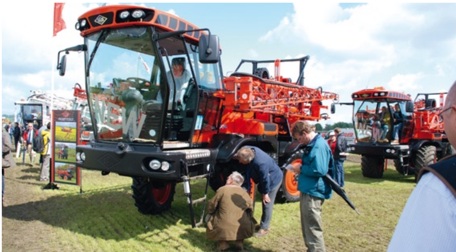
▲ Sands Agricultural Machinery (SAM) heeft zijn zelfrijdende spuiten uitgerust met een nieuwe ruime cabine. Naast goed zitcomfort heeft deze cabine rondom een grote oppervlakte glas, waardoor de bestuurder weinig kan ontgaan. Bij dergelijke grote spuiten vouwen de bomen zich op langs de zijkanten. Om daarvan geen hinder te ondervinden bij het betreden van de cabine, is de cabine uitgerust met een schuivende toegangsdeur. Rechts naast de goed geveerde stoel zit de bedieningsconsole. Op het terrein van veiligheid is er iets opmerkelijks. De cabine heeft geen tweede uitgang. Bij navraag kwamen we erachter dat in Engeland de puntige hamer voor het inslaan van een ruit een goed alternatief is voor een extra uitgang.
