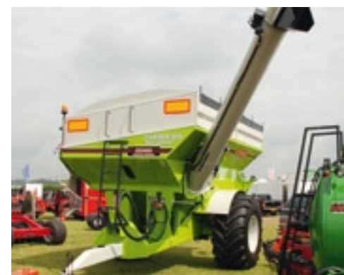
▲ Grote bedrijven, grote percelen en daardoor vaak grote afstanden. Voor het transport van granen wordt vaak een vrachtwagen gebruikt. Die blijft in Engeland op de verharde weg. Om de capaciteit van de maaidorser niet te beïnvloeden, wordt de graantank al rijdend gelost in een overslagwagen. Die lost daarna in de vrachtwagen. De wagen van Simon Cross heeft een laadcapaciteit van 16,5 ton en staat op 30,5x32 banden.
