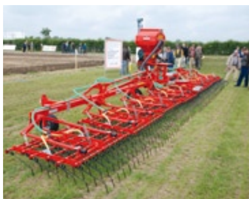
▲ Meer doen in dezelfde tijd en dat zonder verlies van kwaliteit. Die wens speelt overal, ook bij de akkerbouwers in Engeland. Meer capaciteit is haalbaar uit een hogere werksnelheid, bredere machines, meer bewerkingen tegelijk, maar ook uit combinatie van bewerkingen. Voor het inzaaien van onder meer groenbemesters heeft de Oostenrijkse fabrikant Einböck de 12 meter brede, achtdelige Aerostar tandem uitgerust met een pneumatische zaaimachine. Uit de centrale verdeelheid wordt het zaad naar het verdeelpunt op elk segment van de tandeg geblazen en daar verspreid. Voor heel grote oppervlakten is de tandeg ook leverbaar in een getrokken uitvoering tot 24 meter breed.
