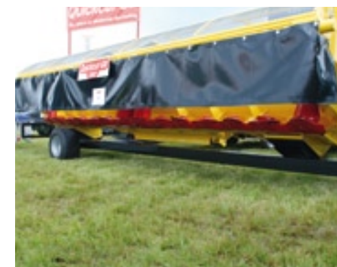
▲ Voor de oogst van het totale gewas, variërend van voergraan (gehele plant) tot olifantgras, maakt Quickcut GB voorzetstukken voor veldhakselaars. Voor een werkbreedte van 580 cm heeft de Quickcut 580 een Lely-schijvenmaaier met veertien schijven die 3.000 omw./min maken. Tijdens het werk drukt de voorzijde het gewas eerst plat. In de bak zitten vijzels voor het transport naar de invoereenheid. Het brede voorzetstuk weegt 2.500 kg en is te gebruiken op de veldhakselaars van John Deere, Claas en New Holland. Voor het vervoer over de openbare weg levert de fabrikant een transportwagen mee.
