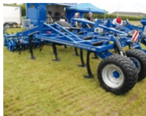
▲ Köckerling heeft op elke tand van de 5,7 meter brede zware Vector-veertandcultivator een hydraulische cilinder gemonteerd om de werkdiepte te kunnen regelen. Alle cilinders zijn met elkaar verbonden. Vanuit de trekercabine kan de druk worden bijgesteld. Ondervindt een tand meer druk dan de andere, dan drukt deze tand via het systeem van communicerende vaten olie naar andere veertanden. Voor de diepteregeling is een hydraulische cilinder tussen het frame en de wielstellen geplaatst. Over een stangenstelsel worden de veranderingen doorgegeven aan de aandrukrollen.
