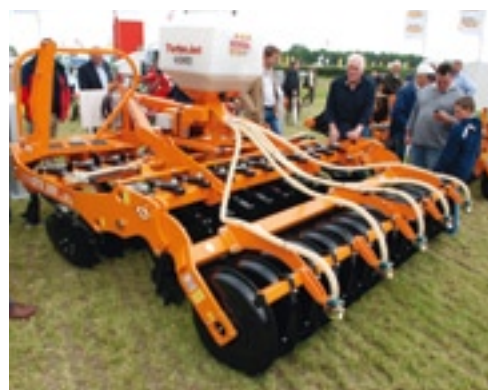
▲ Ook Simba brengt zo'n gecombineerde machine op de markt, maar dan met grote schijven aan zware veertanden. In tegenstelling tot andere fabrikanten verstelt Simba de grijpende hoek van de schijven door de veertanden te verdraaien met een spindel. Om het probleem van aankloekende grond op een rol heeft Simba op originele wijze opgelost. Op de kunststof rol zitten trechtertjes van stevig, maar wel beweegbaar materiaal. Als vochtige grond aan de rol wil gaan plakken zorgt de werking van de trechters ervoor dat de aanklevende grond losbreekt en de rol schoon blijft.
