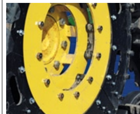
▲ Opvulbussen aan de buitenzijde om de juiste spoorbreedte te krijgen.
