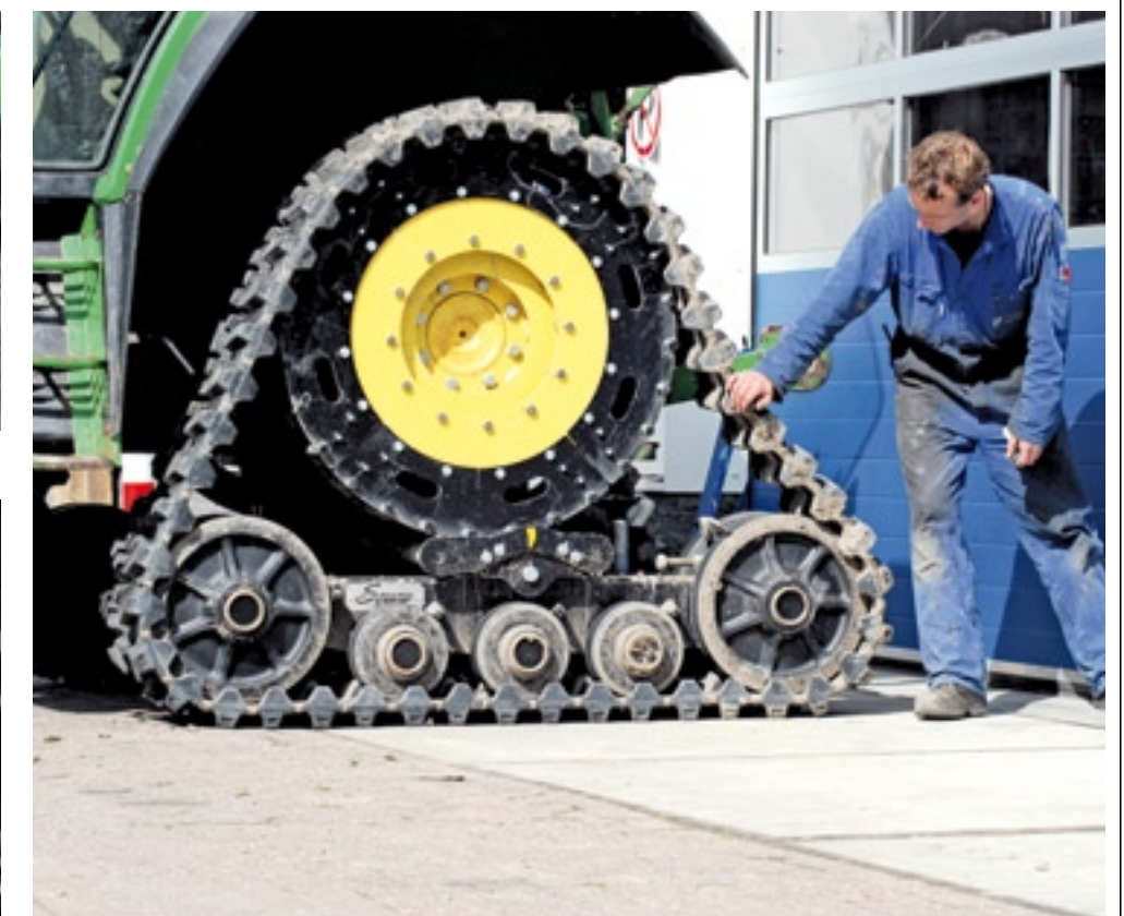
▲ Op de Soucy rups staat geen spanning, je kunt hem indrukken. Nokken aan de binnenzijde brengen alle krachten over.
