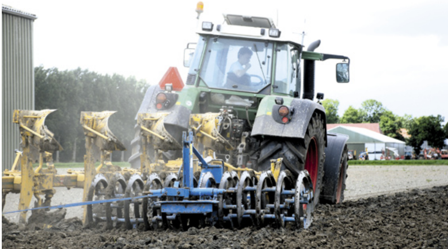
▲ Zonder rtk-gps is er veel overlap. Uit metingen tijdens het klaarleggen van 10 hectare aardappelland en 10 hectare bietenland kwam naar voren dat 1 hectare grond dubbel bewerkt was.
