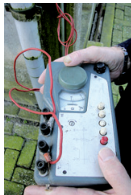
Een bliksem afleider heeft een lage weerstand waardoor de stroom veilig naar de aarde kan afvloeien. Laat de bliksem afleiding regelmatig doormeten.
