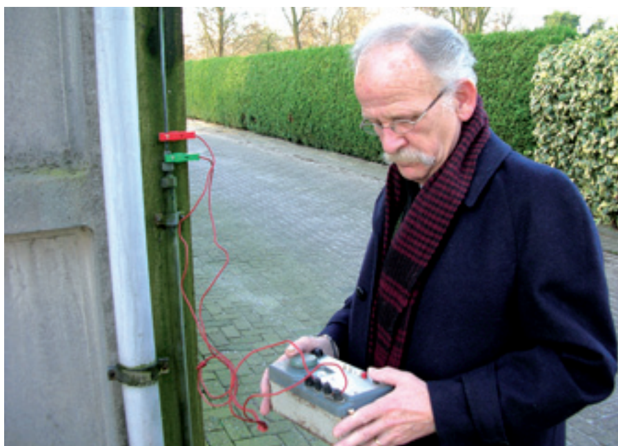
Een bliksem afleider heeft een lage weerstand waardoor de stroom veilig naar de aarde kan afvloeien. Laat de bliksem afleiding regelmatig doormeten.
