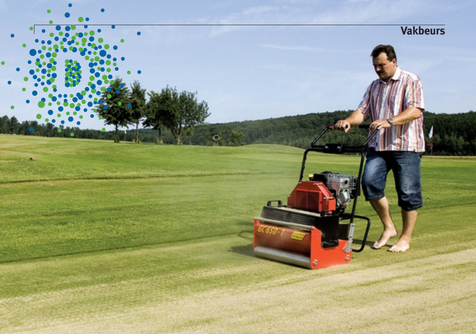
Een ingenieuze machine is de Ettrich. Met deze handmachine maak je een net beluchte en bezande green direct weer bespeelbaar.
