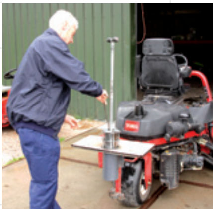
Bij het maaien van de greens worden ook meteen de holes verplaatst. Hiervoor zit er een hulpstuk op de maaier om de holesteker mee te nemen.
