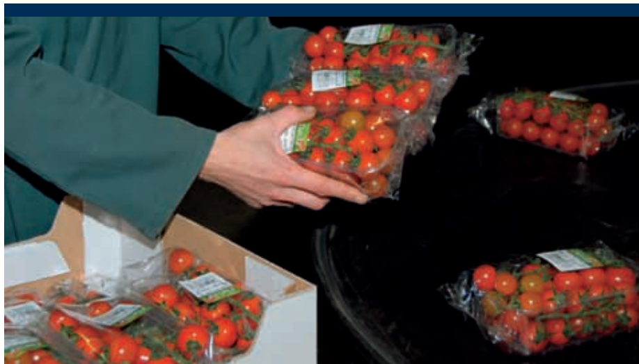
Bij het inpakken moeten de medewerkers, afhankelijk van het type, drie schaaltes naast elkaar of twee op elkaar tegelijk in de dozen zetten.
