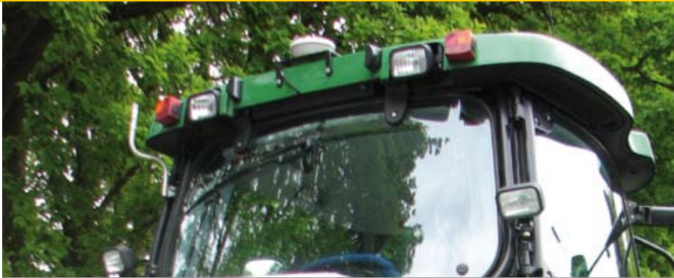
De GPS ontvanger is bovenop de tractorcabine gemonteerd.
