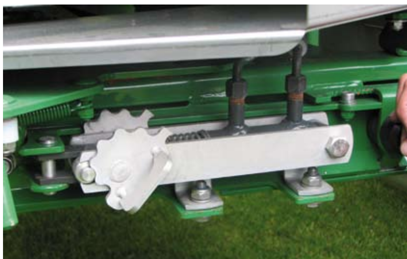
Eerst per meststof de stroobreedte en kantstrooien instellen.
