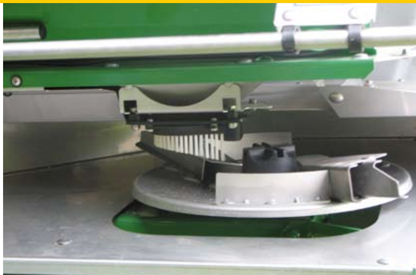
Een van de twee strooischijven of spinners.
