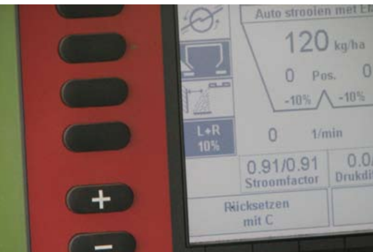
De computer van de geavanceerde kunstmeststrooier. GPS ontvanger kunstmeststrooien
