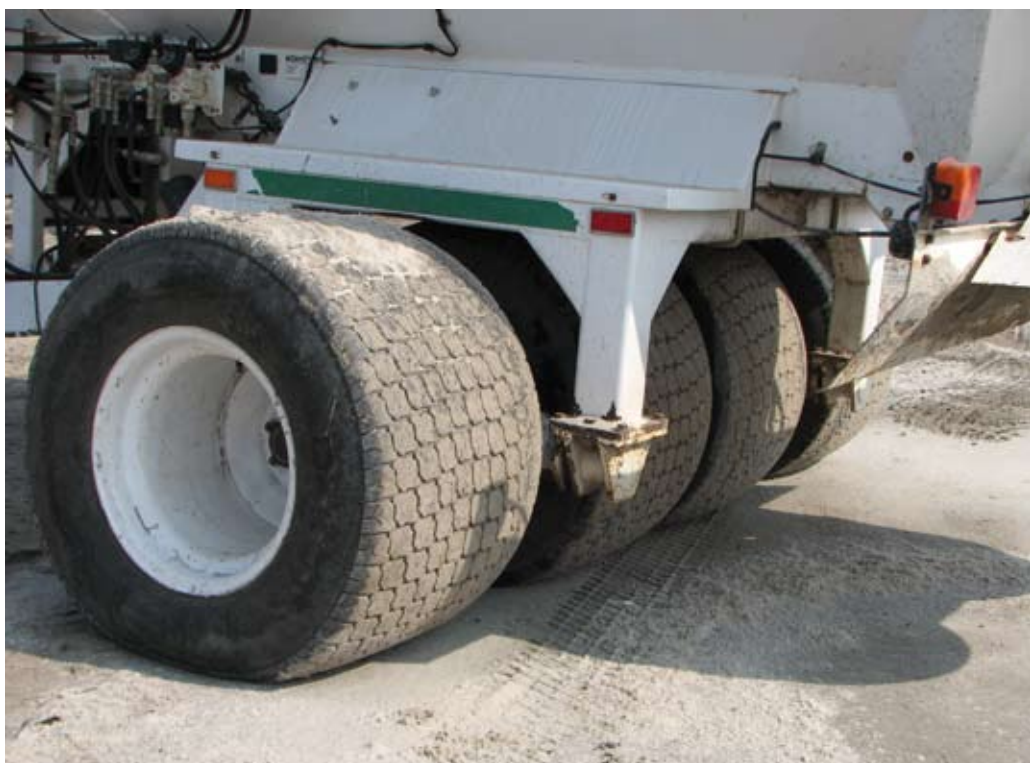
De twee tandemstellen met elk twee wielen, die naadloos het terrein volgen.
