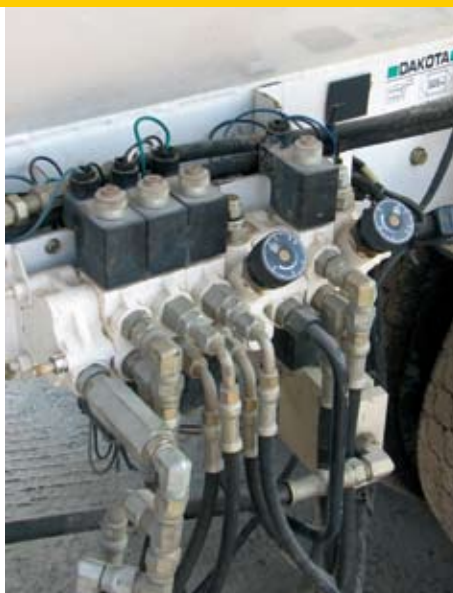
De knoppen voor de hydromotoren op de Dakota 440 voor een nauwkeurige instelling van de dosering.
