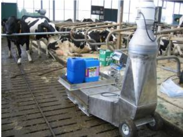
Figuur 3 De meetbox op de roostervloer
