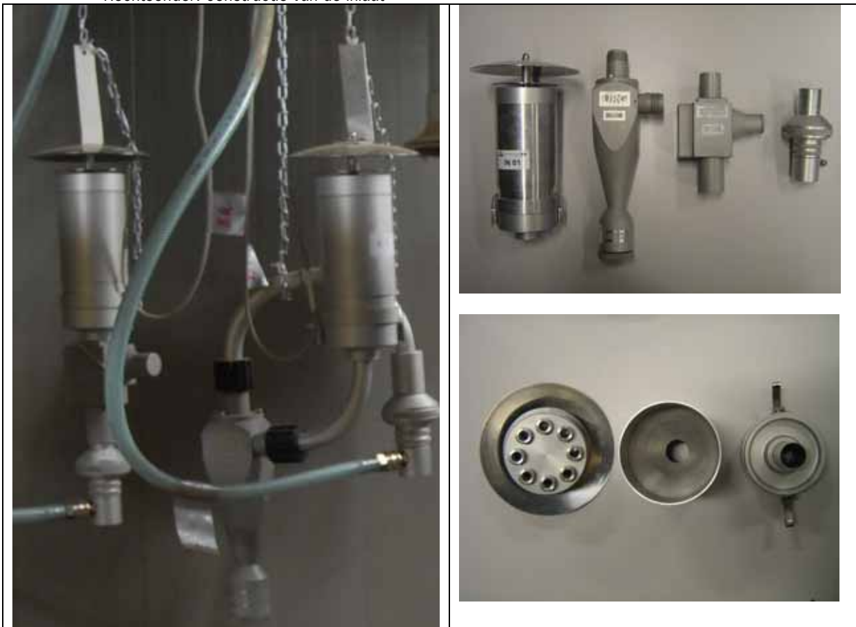
Figuur 1 Meetopstelling voor PM10 en PM2.5 stof concentratiemeting. Links: Meetopstelling op locatie. Rechtsboven: inlaat, de PM10 en PM2.5 cyclonen en de filterhouder (van links naar rechts). Rechtsonder: constructie van de inlaat
