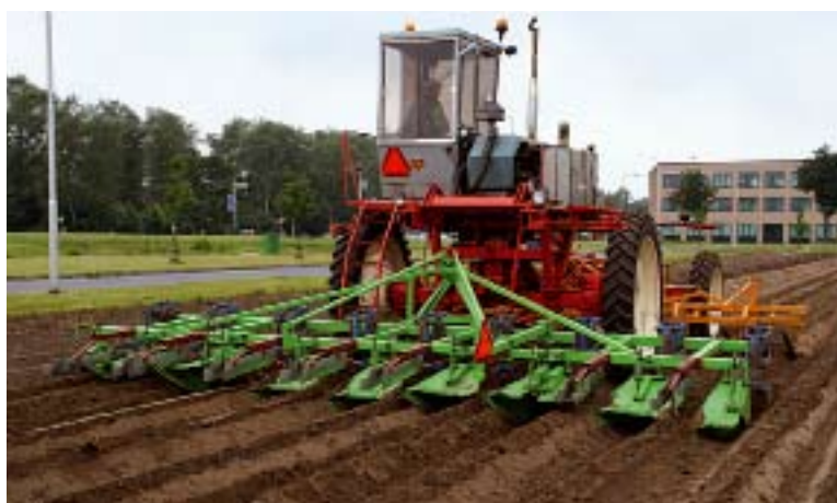
Voor de opbouw van ruggen en gewasverzorging is een werktuigdrager op spoorbreedte van 3,15 meter prima geschikt
