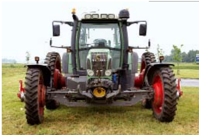
Bij SBF is de spoorbreedte vergroot tot 3,15 meter
