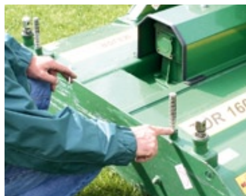
De hoogte kun je aflezen aan de stalen ringen naast de bouten.
