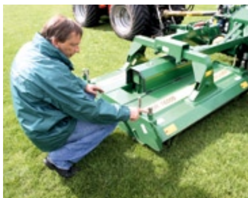
Door vier bouten te verdraaien, verstel je de maaihogte.
