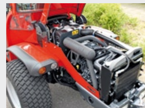
Onder de motorkap ligt een zuinige Perkins van 38 pk. De oliekoeler is nu te verwijderen.
