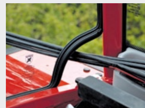
Onderin de achterruit zit nu zowel links als rechts een gat voor kabeldoervoer.
