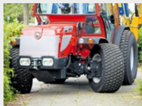
Rij je achterstevoren, dan draait de trekker kort door de 'achterwiel'besturing.
