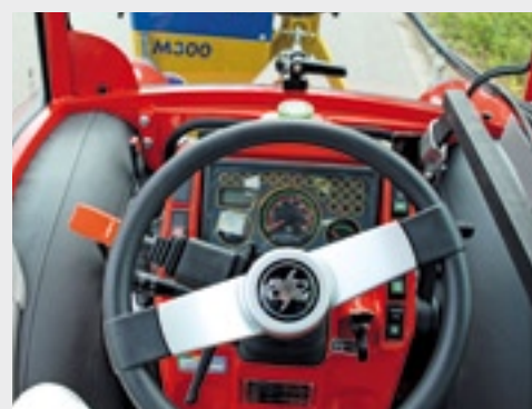
Door de omgekeerde stuurinrichting is er goed zicht op een werktuig in de hef.
