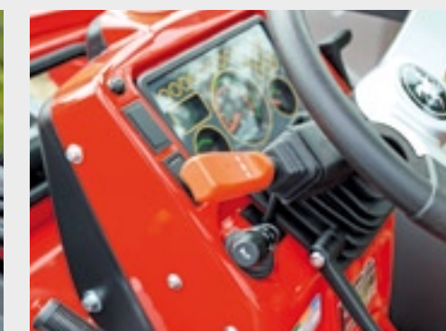
Met de oranje powershuttlehendel links onder het stuur is snel van rijrichting te veranderen.
