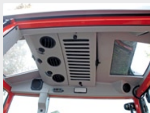
In het dak zitten twee dakramen, waardoor er bij zowel voor- als achteruit werken zicht naar boven is.
