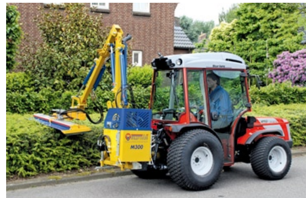
De hef kan 2.100 kg tillen. Doordat je omgekeerd in de cabine zit, heb je met de maaiaarm in de hef goed zicht op het werk.
