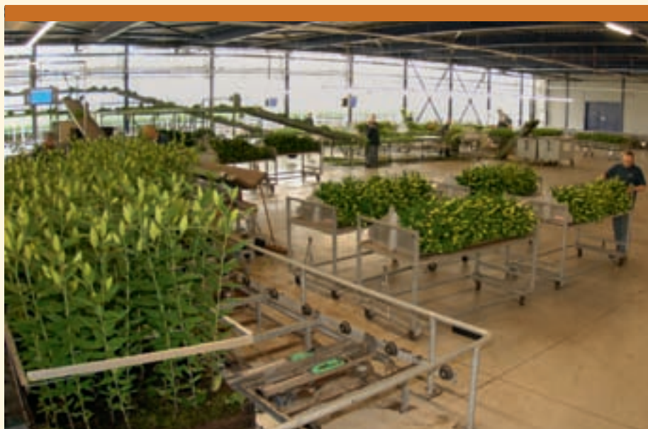
De rolcontainers met de kratten komen automatisch naar de verwerkingsruimte. Niemand hoeft voor gewashandelingen de kas in.
