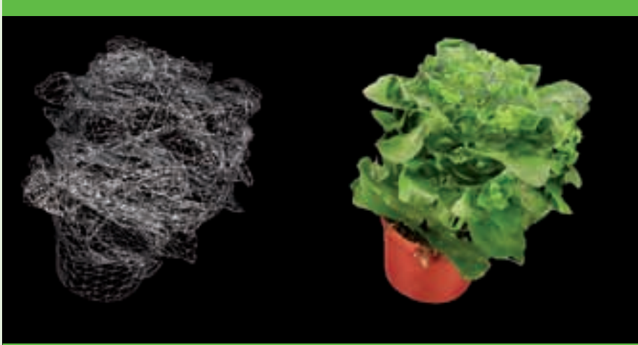
Bij volumetric intersection roteert een object voor de camera's. Met behulp van software is een volledig 3D-model in kleur van de plant te reconstrueren.
