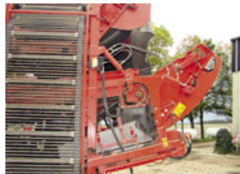
De egelbanden en de axiaalrollen zijn in helling verstelbaar.
