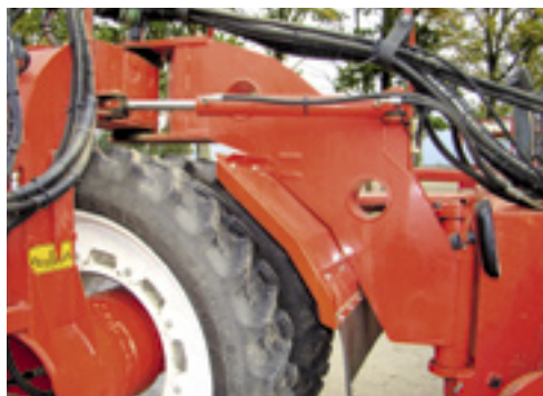
Door de zwanenhals is de machine wendbaar en kun je veel afstand nemen van de ruggen.
