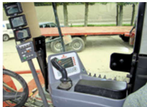
Door de Commander Unit is de machine gemakkelijk te bedienen.
