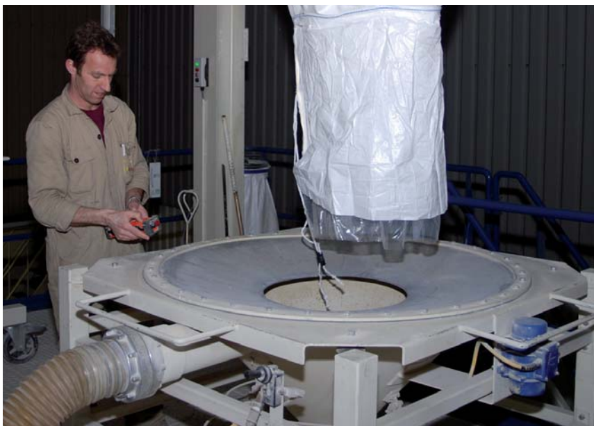
Een big bag lossen op de speciale losinstallatie met afzuigaansluiting.
