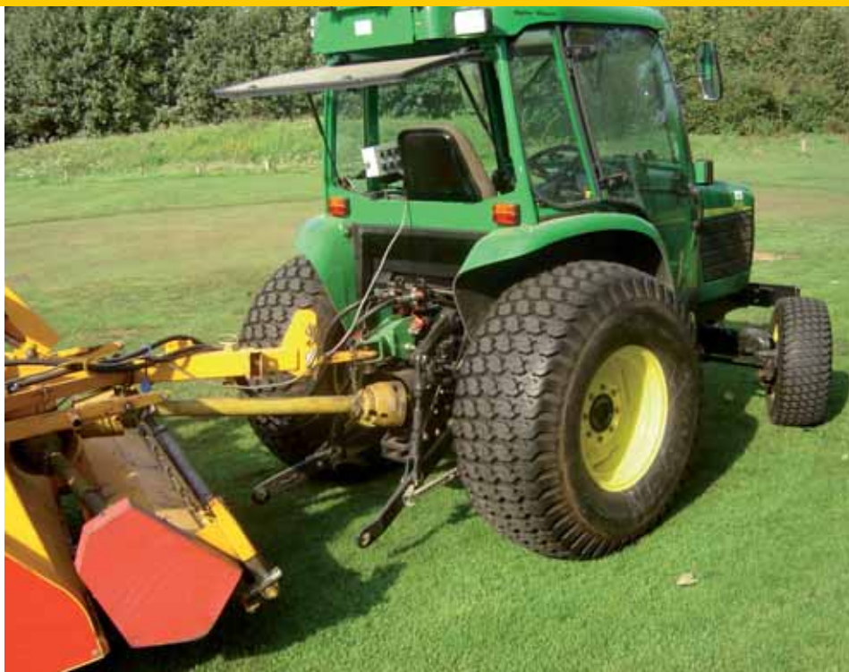
Grof noppenprofiel op een brede band en lage bandenspanning (0,8 bar) zorgt voor een minimale belasting van de grasmat. Het grove noppenprofiel kan daarbij een redelijke trekkracht uitoefenen zonder teveel slip.
