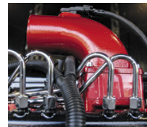
▲ De nieuwe zevencilinder 'in lijn' heeft een commonrail-inspuiting van het Duitse Bosch. De elektronica is van de Finse fabrikant zelf.
