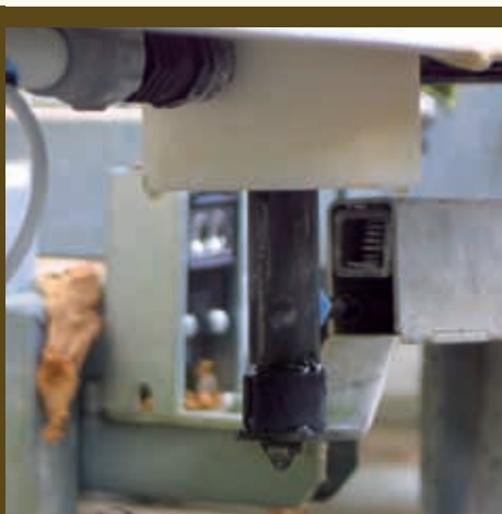
Wanneer de medewerker een roulatieopdracht geeft, wordt een eventuele gietbeurt onderbroken. Bij de volgende stop - en de volgende kraan - wordt de gietbeurt hervat.
