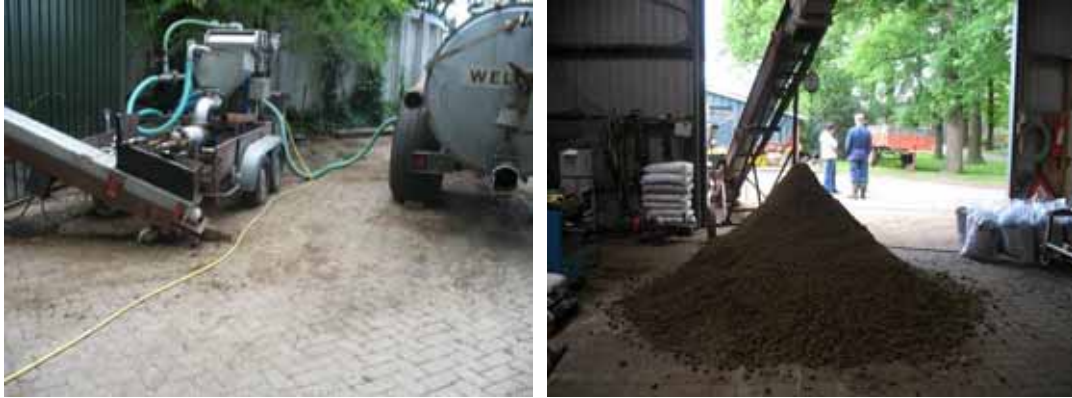
Impressie van de vijzelpers en de daarmee uit drijfmest geperste dikke fractie
