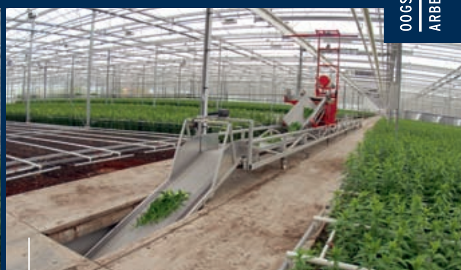
Groenewegen heeft een systeem van BTM waarbij de band onder het hoofdpad naar de schuur loopt.
