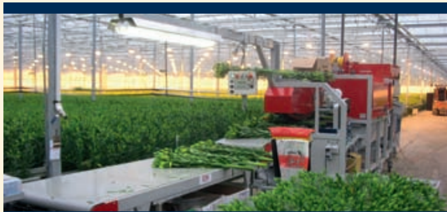
Zowel Bercomex als BTM hebben systemen waarbij de bosmachine op het hoofdpad staat. Het bossen van de lelies vindt dan in de kas plaats.
