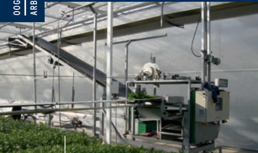
Bij het systeem van Bercomex komen de lelies, via de oogstband in de kap, automatisch op een band boven het hoofdpad...
