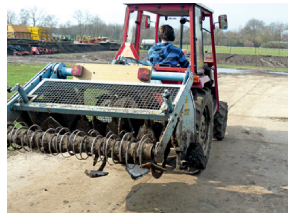
De achterlichten van de trekker zijn door het werktuig in de hefinrichting niet meer te zien. Een verlichtingsbalk op het werktuig en schone, goed afgestelde spiegels verhogen de verkeersveiligheid.
