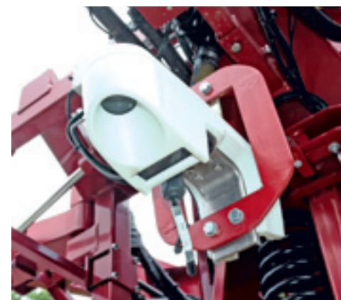
De GreenSeeker sensor ziet er uit als een lamp. Hij straalt licht uit om vervolgens de reflectie daarvan te meten.
