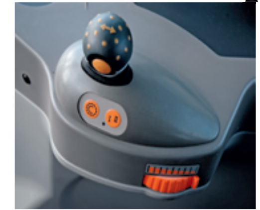
Het pookje heeft bij de 300-serie de vorm van een golfbal. Rechtsonder zit het handgas.
