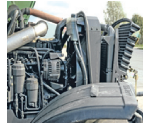
De Deutz viercilinder is voorzien van een turbo en intercooler en springt bijzonder zuinig met brandstof om.
