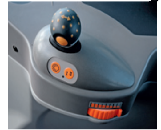
Het pookje heeft bij de 300-serie de vorm van een golfbal. Rechtsom zit het handgas.
