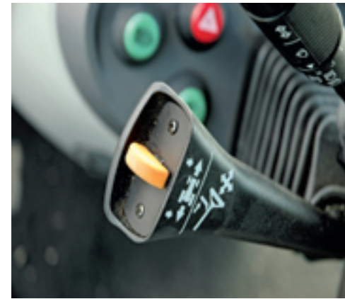
Van richting wisselen kan met de hendel onder het stuur en het Vario-pookje.
