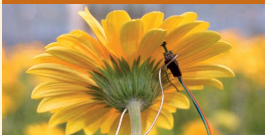
Kleine dataloggers brengen het microklimaat rond de bloem in kaart. Dat kan sterk verschillen van het ingestelde kasklimaat.
