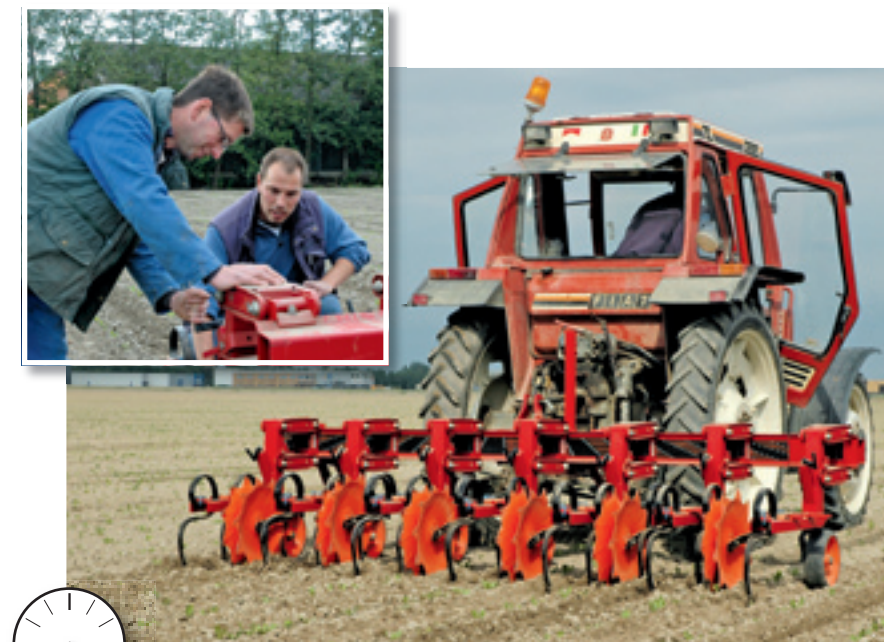
Frank Hoitink (links) en Erik Juurlink zijn bezig met de 'fijnstelling' van de Kongskilde Vibro Crop van Frank die achter de Fiat 580 DT van Juurlink zit. De cichorei staat er redelijk op, maar het kruiskruid beter. Dat moet net voor het bloeien toch wel een kopje kleiner. De oude maar lichte Fiat (met bijna 10.000 uren op de teller) neemt op dit moment de plaats in van de moderne maar relatief zware trekker van Hoitink, omdat ze onnodige bodemverdichting willen voorkomen. Hoitink en Juurlink werken niet 'officieel' samen, maar doen vooral aan burenhulp.
