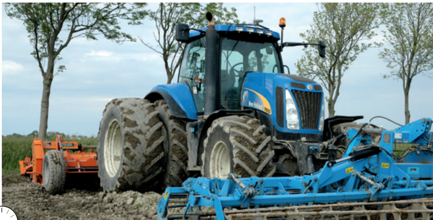
De zware New Holland T8020 van Granneman uit Slootdorp wacht aan de Dolfijnweg op de dingen die komen gaan. Een hakenfrees van Struik en een Quars 7 zaai-bedcombinatie van Lemken houden hem gezelschap. De zelfrijdende rupsaangedreven achtrijige plantmachine van Tumoba uit Barendrecht staat een paar meter verderop. De ontvanger van het rtk 'global positioning system' SBGuidance op de trekkercabine zorgt ervoor dat de blauwe krachtpatser en de planter recht door (de voormalige) zee gaan. De combinatie werkt 6 meter breed en de trekker staat op dubbellucht in de maat 710/70R42.
