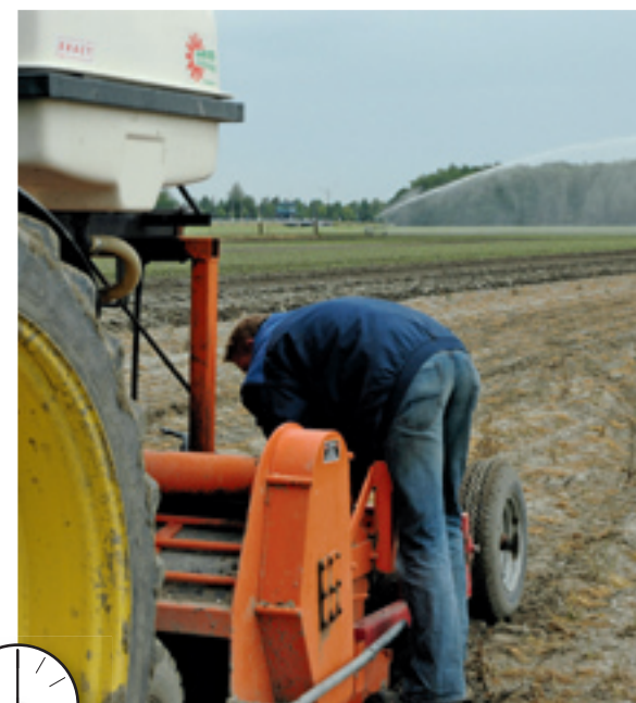
Robin Hiemstra van de gelijknamige firma uit Middenmeer is voor deze dag klaar met het planten van ijsbergsla en steekt wat grond van de pakkerrol van de hakenfrees. Achter deze frees wordt aan weerszijden van de nog te planten sla vloeibare kunstmest in de grond gebracht en preventief gespoten tegen onkruid. Op de achtergrond het beregenen om de plantjes op de lichte grond beter aan te laten slaan.
