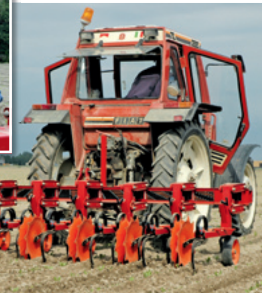
Frank Hoitink (links) en Erik Juurlink zijn bezig met de 'fijnstelling' van de Kongskilde Vibro Crop van Frank die achter de Fiat 580 DT van Juurlink zit. De cichorei staat er redelijk op, maar het kruiskruid beter. Dat moet net voor het bloeien toch wel een kopje kleiner. De oude maar lichte Fiat (met bijna 10.000 uren op de teller) neemt op dit moment de plaats in van de moderne maar relatief zware trekker van Hoitink, omdat ze onnodige bodemverdichting willen voorkomen. Hoitink en Juurlink werken niet 'officieel' samen, maar doen vooral aan burenhulp.
