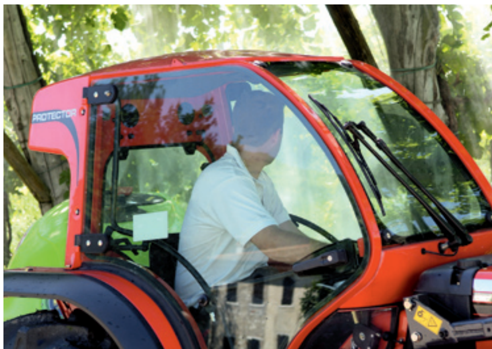
▲ Bij de nieuwe overdrukcabine van Antonio Carraro gaat op het display een rode lamp flikkeren als het koolstoffilter vervangen moet worden.
