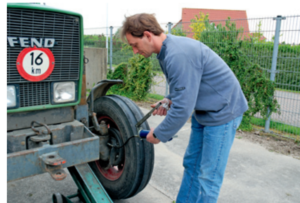
▲ Bij het doorsmeren van trekkers en machines gaat het om het gebruik van het juiste gereedschap, de goede vetsoort en op de aangegeven manier werken. Goed smeren doe je met gevoel.
