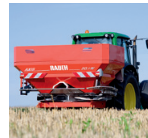
▲ PPO in Lelystad gebruikt de Axis 50.1 sinds najaar 2008. Deze capaciteitsstrooier heeft een werkbreedte van 50 meter en een bakinhoud van 4 ton.
