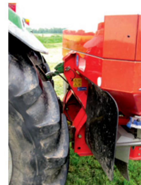
▲ De strooier heeft twee kunststof flexibele spatlappen. Deze zijn tegenwoordig van hard kunststof.
