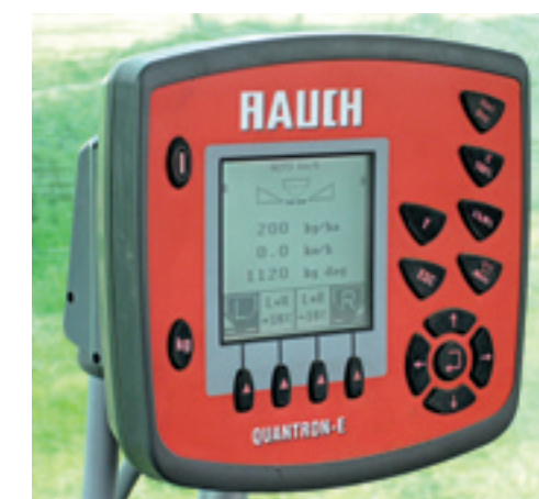
▲ De grensstrooi-inrichting werkt erg goed, maar Sjors Roelofs mist een waarschuwingssignaal op de Quantron-E bedieningsterminal.
