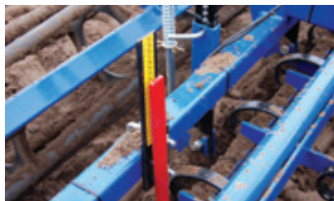
Op de dieptemeters is de werkdiepte van de hydraulisch verstelbare tanden te zien. De laatste meter is vanaf de cabine slecht zichtbaar.
