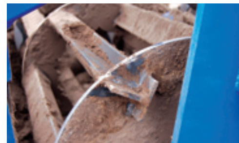
De T-profielspijlen kunnen minder of meer agressief worden gemonteerd. Door de rol om te keren verandert de werking. Hier is hij dragend gemonteerd.
