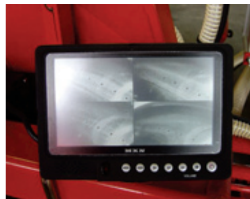
Alle vier de zaaischijven zijn goed in de gaten te houden op het beeldscherm.
