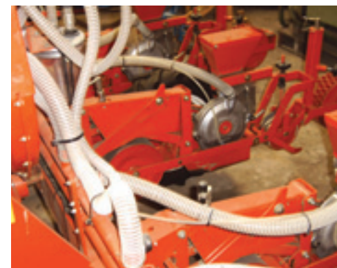
Het zaaielement rust op de twee wielen zodat de zaaidiepte goed afgesteld kan worden met de spindel.
