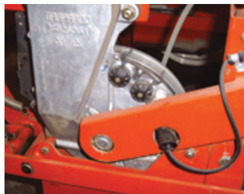
Met behulp van twee stelknoppen zijn de afschrapers gemakkelijk te verstellen. Tevens is te zien hoe de camera op de zaaddistributeur gemonteerd is.
