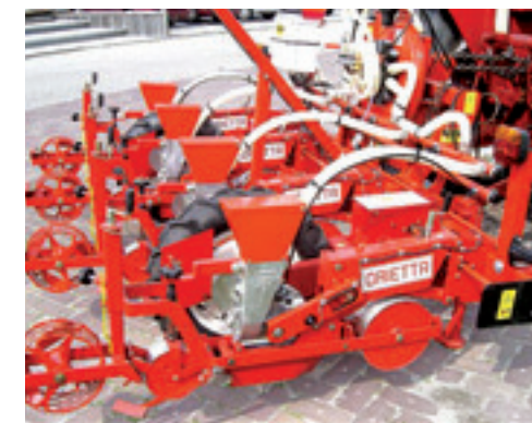
Voor het zaaien van wortels wordt er gebruik gemaakt van een 4-rij zaaimachine. De nieuwe kooiwielen zijn voor een groot deel open om zoveel mogelijk grond te lozen.
