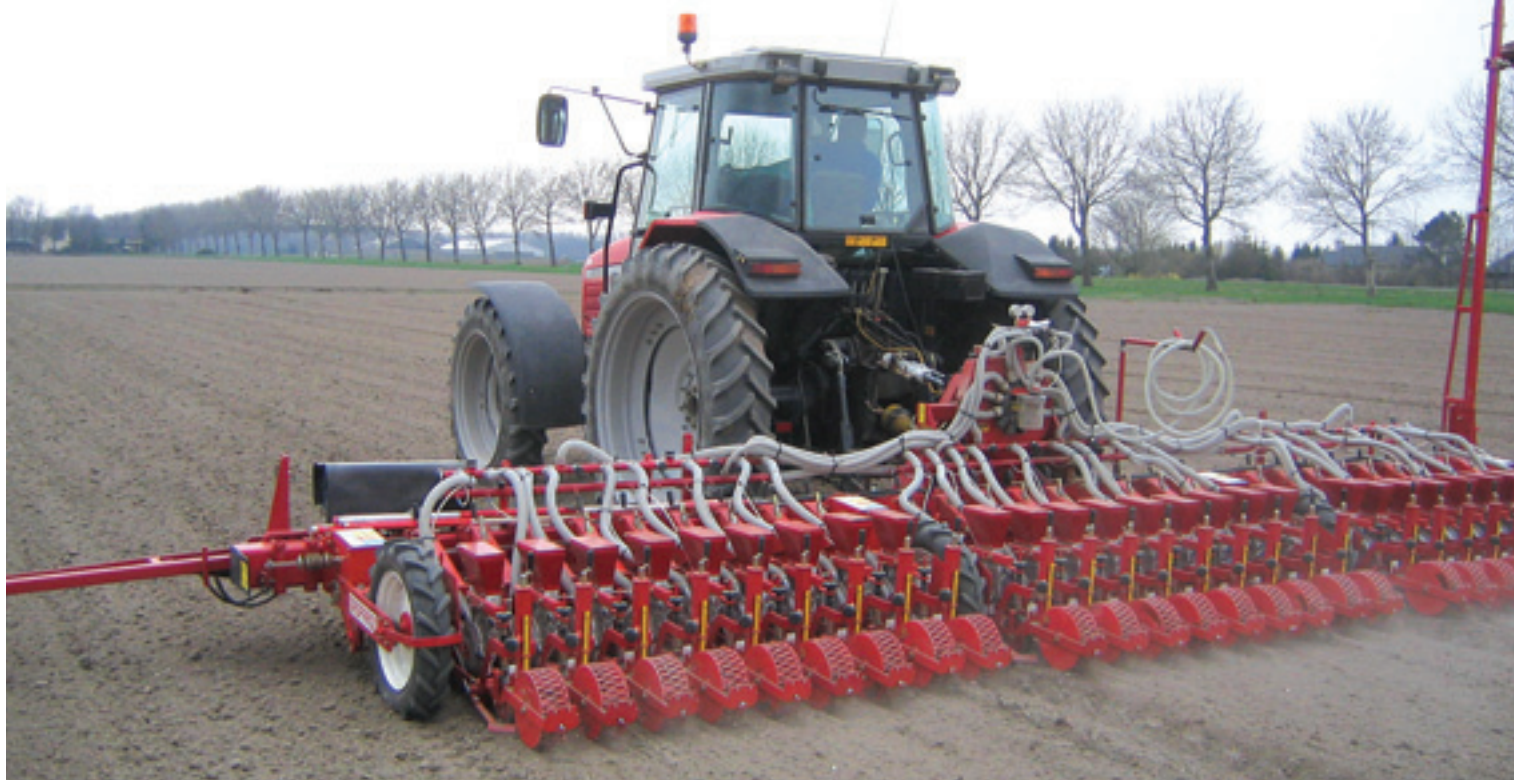
Loonbedrijf Bijdevaate heeft drie Gaspardo zaaimachines: een 4-rijer voor wortels en witlof, en een 15- en 27-rijer voor uien. Op de 4-rijer zit geen camera omdat er bij aankoop niet aan gedacht is. Op de bredere machines kan nog geen camerasysteem, hier wordt aan gewerkt.
